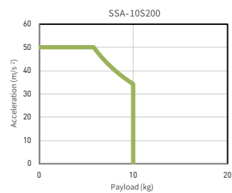
Curva di accelerazione-carico
